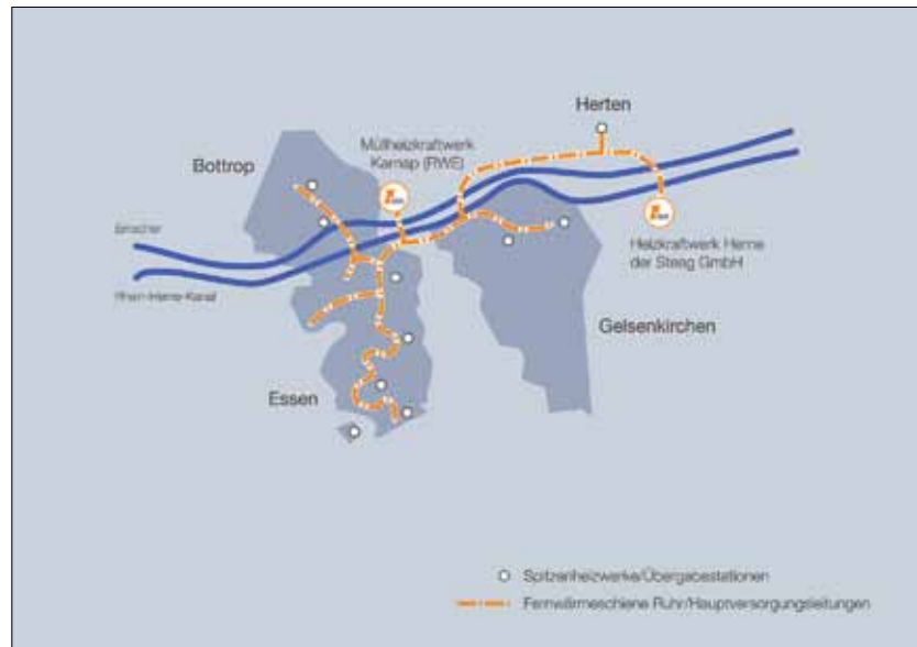
Die Fernwärmeschiene Ruhr, das erste überregionale Fernwärmeverbundsystem in Deutschland, verbindet die Fernwärmenetze in Bottrop, Essen und Gelsenkirchen
